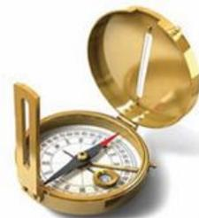
На этом принципе работает компас, основной частью которого является магнитная стрелка. Компас был изготовлен около двух тысяч лет назад. Один из первых компасов – древнекитайский. Роль стрелки в нем выполняла магнитная «ложка», которая легко поворачивалась вокруг вертикальной оси. Такой компас назывался «указатель юга».
